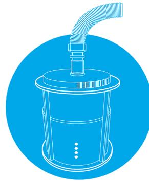
*CONTRAfluran™ ist ein durch internationale Patente und weitere Patentanmeldungen geschütztes Verfahren, mit dem inhalative Anästhetika vollständig aus der Expirationsluft eines Patienten adsorbiert werden.*
